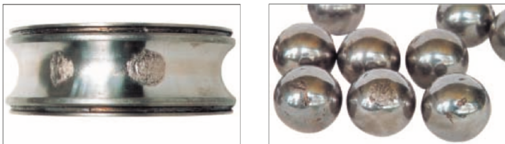
Figura 1 – Escamação na pista e em esferas [9].
