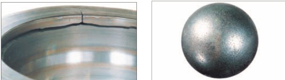
Figura 2 – Trinca na pista e pitting em esfera [9].
