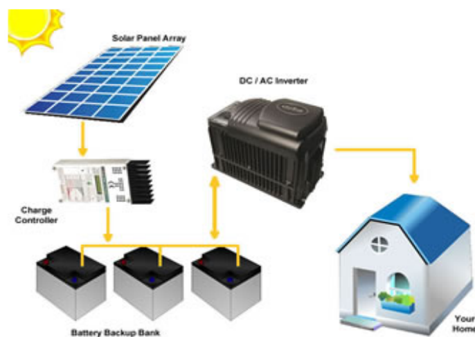
Figura 6 – Esquema de funcionamento de um sistema Off Grid
