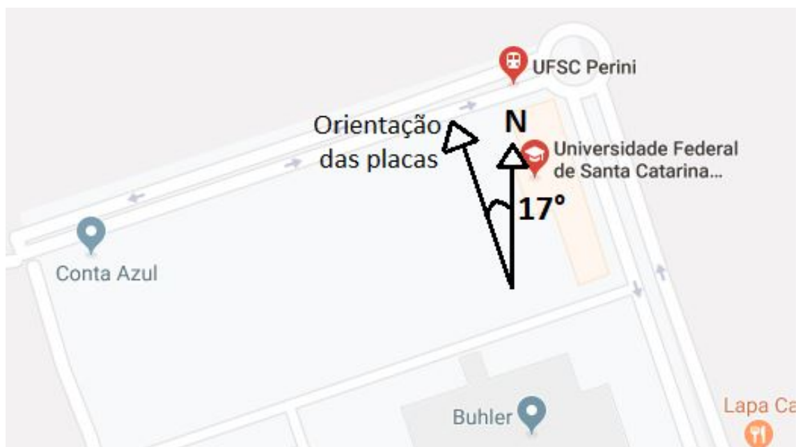
Figura 21 – Relação trigonométrica para obter orientação
