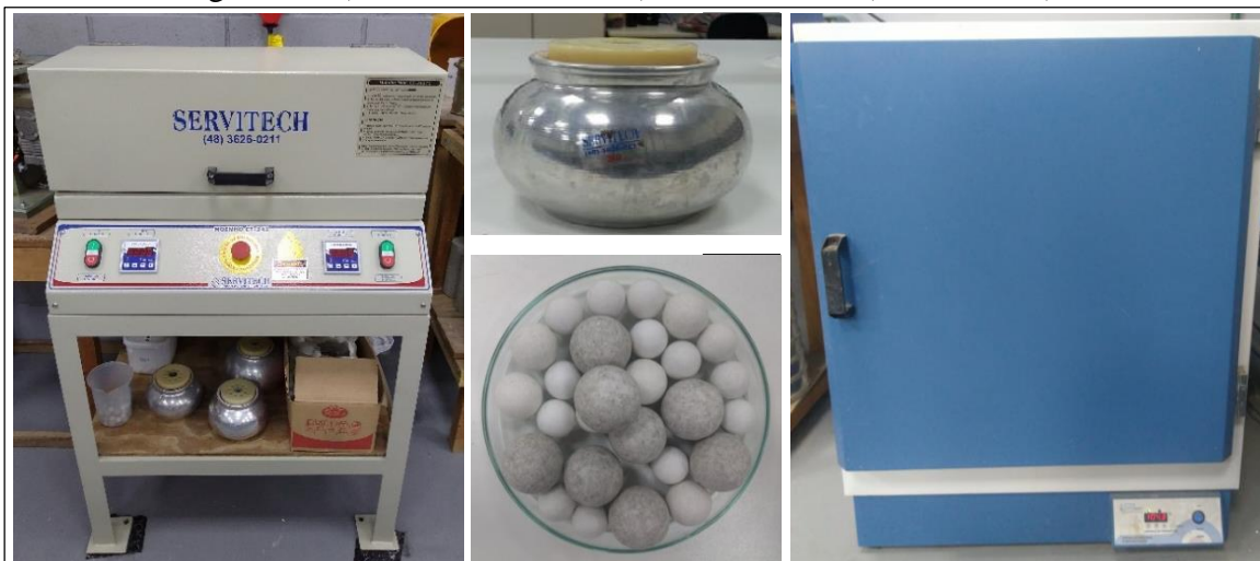
Figura 9 – a) Moinho de bolas; b) Jarro 300 ml; c) Esferas e d) Estufa.
