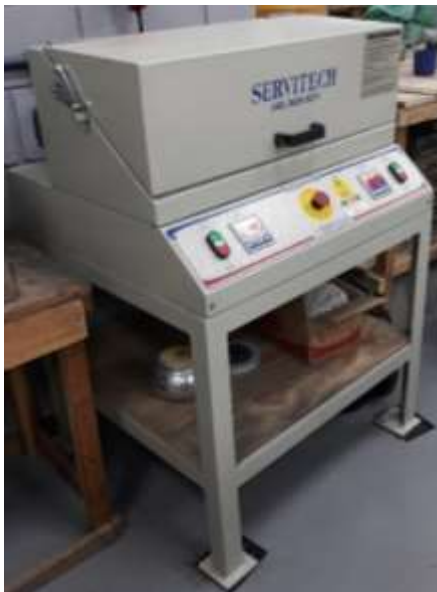
Figura 8 – Moinho utilizado na moagem da cinza de madeira
