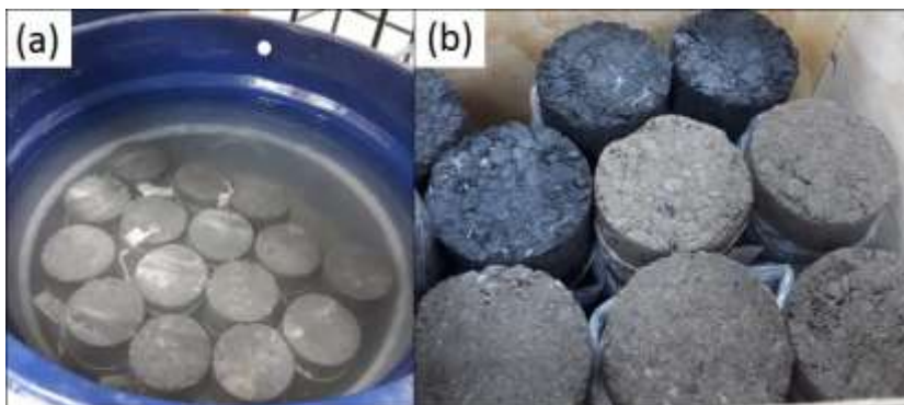
Figura 21 – Imersão dos corpos de prova (a); Corpos de prova após 28 dias de cura (b)
