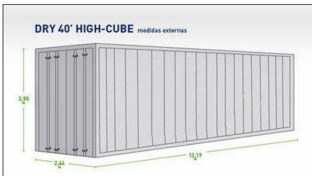
Figura 2 - Contêiner do tipo Dry Box High Cube de 40 pés
