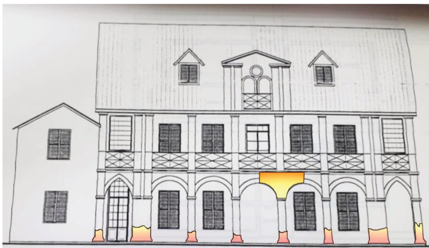
Figura 31 - Áreas afetadas na fachada leste pela umidade
