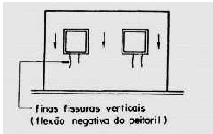
Figura 21 - Finas fissuras verticais nos peitoris da janela provocadas por recalques diferenciais
