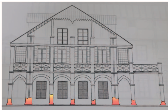
Figura 34 - Regiões afetadas por manifestações patológicas decorrentes da umidade na fachada Norte
