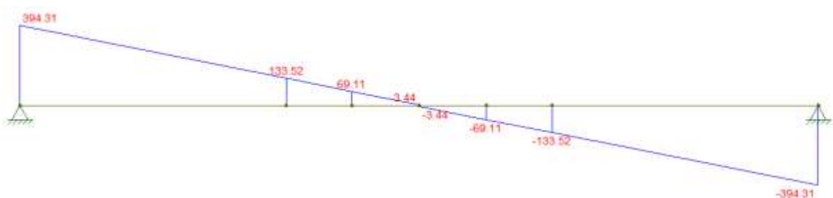
Figura 15 - Esforços cortantes das cargas permanentes na longarina
