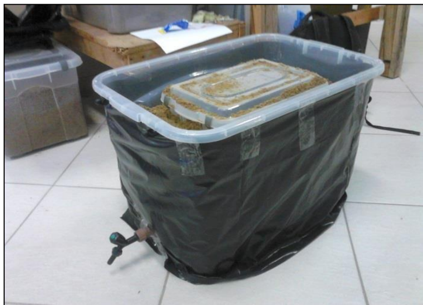
Ilustração 3: Piloto do reservatório contendo areia
