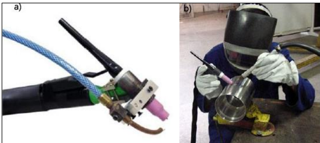
Figura 2 - Dispositivo de alimentação mecanizada de arame, acoplado (a) e não acoplado (b) a tocha de soldagem
