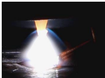
Figura 4 – Imagem demonstrativa do modo de transferência metálica em ponte
