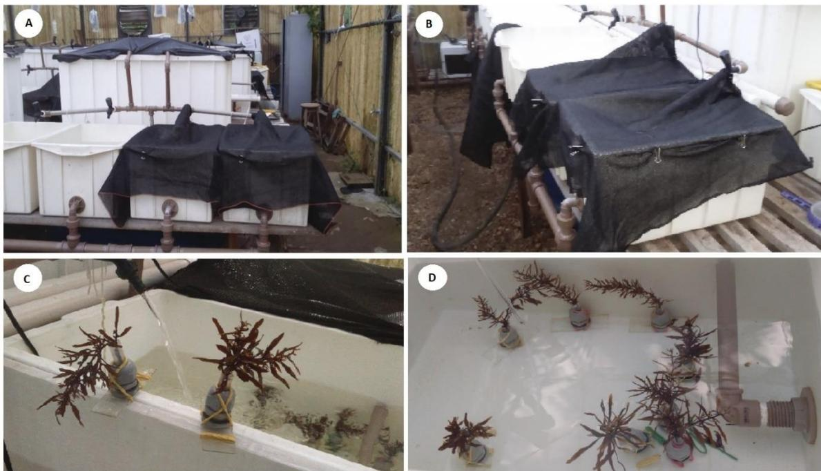
**Figura 2.** A-D Imagem interna do sistema de mesocosmos, na casa de vegetação. A-B) Disposição dos tanques e testes da estrutura e adição de sombrites para a determinação do percentual de sombreamento. C) Apressórios artificiais onde foram colocados os ápices de *S. Stenophyllum* D) Disposição dos Ápices dentro do tanque, de forma padronizada, de acordo com a hidrodinâmica.
