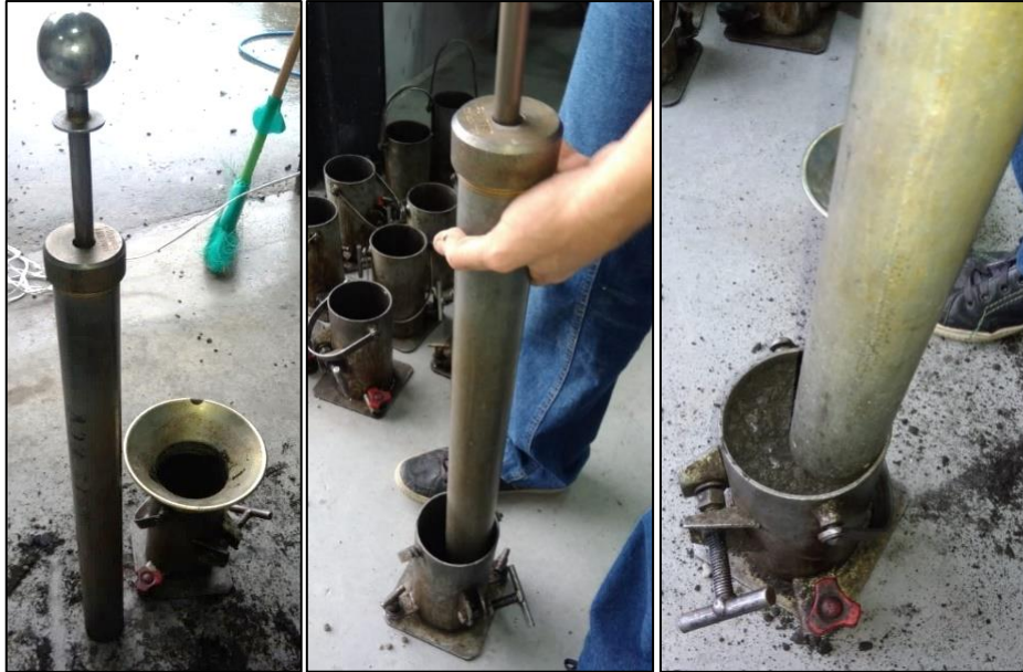
Figura 18 - Moldagem dos corpos-de-prova.
