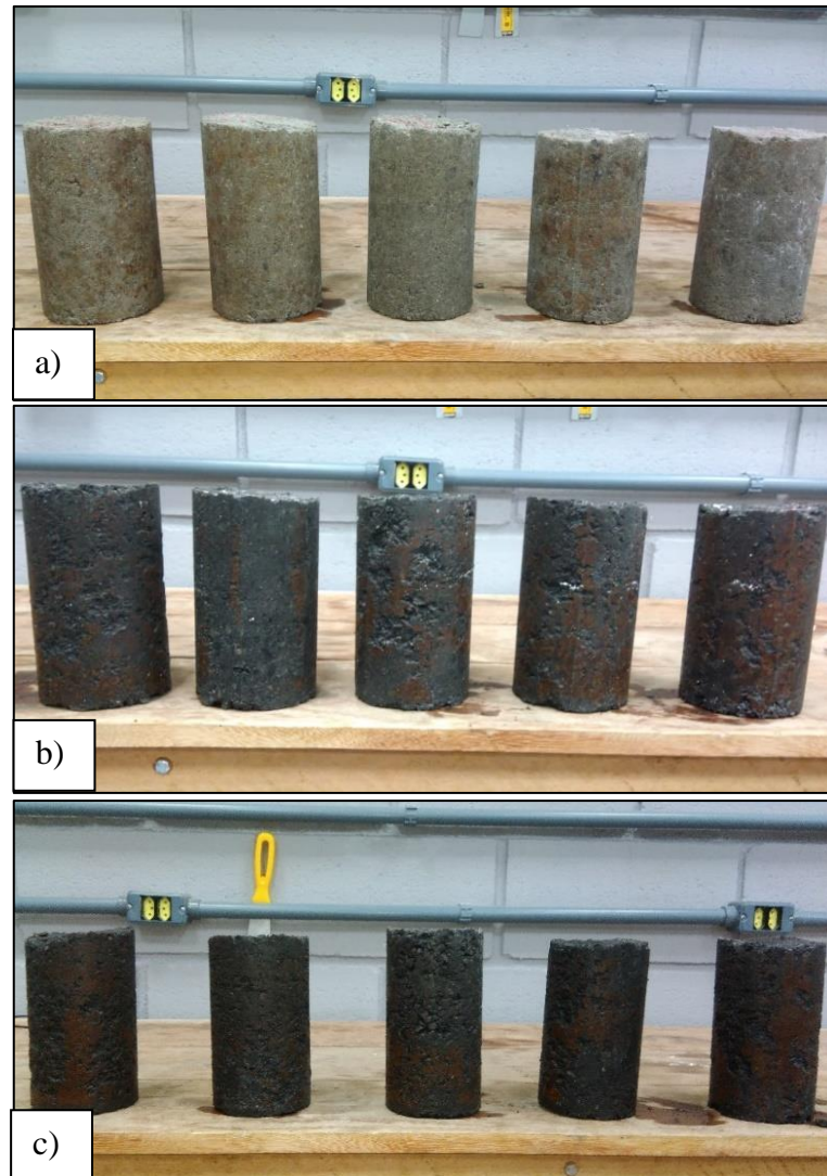
Figura 20 - Corpos-de-prova de CCR aos 7 dias de cura: a) Traço referencia; b) 10% de cinzas e c) 15% de cinzas.
