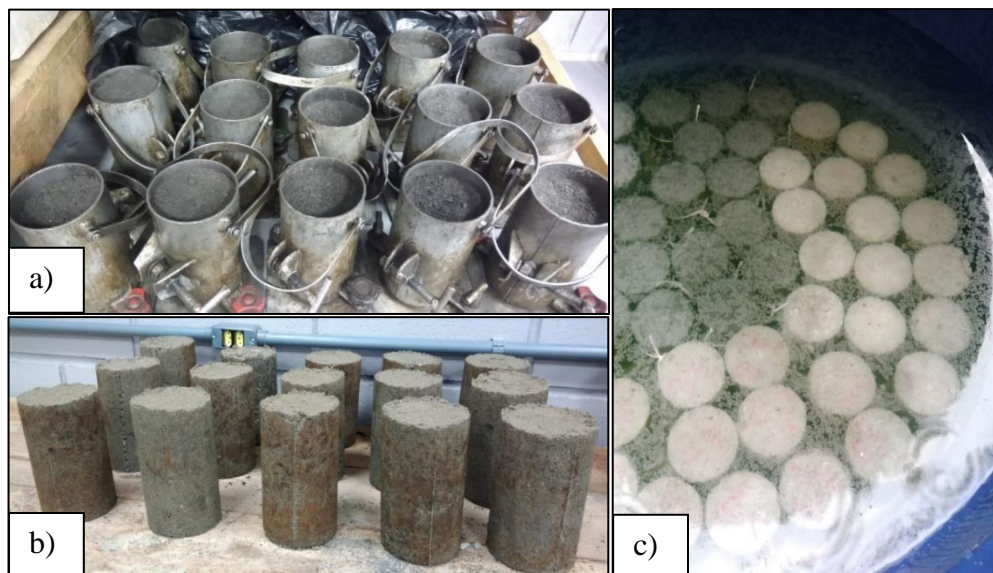
Figura 19 - a) Cura primeiras 24h; b) CPs logo após desmolde e c) Cura final em imersão.
