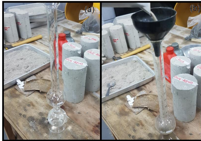
Figura 17 - Frasco com 200 cm 3 de água (a); Preenchimento do frasco com agregado miúdo (b).
