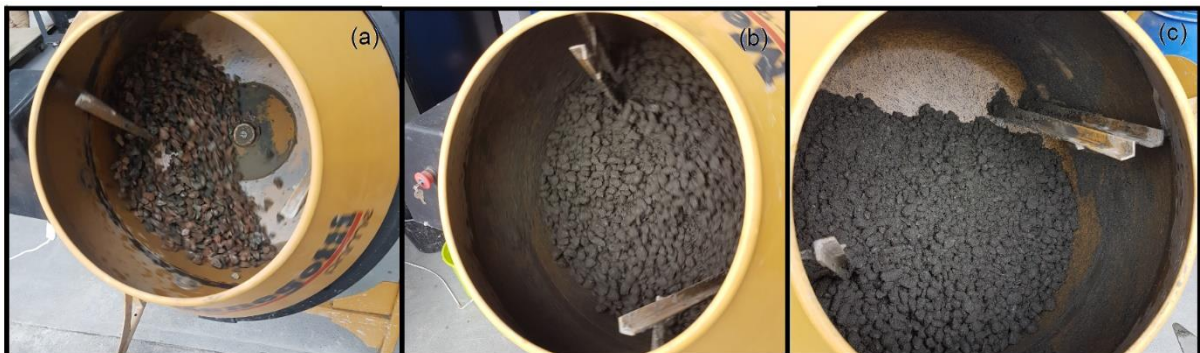
Figura 19 – Colocação dos agregados graúdos (a); Colocação do cimento (b); Colocação do agregado miúdo e cinza de madeira (c).
