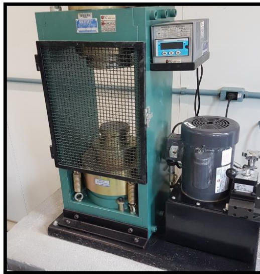
Figura 15 – Equipamento utilizado para o ensaio de resistência à compressão simples.
