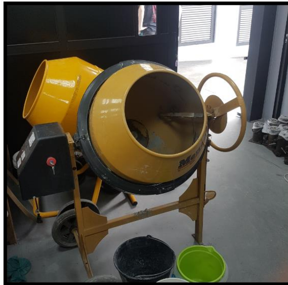
Figura 13 - Betoneira utilizada na confecção dos CP.
