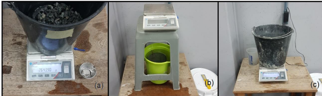
Figura 16 - Pesagem do agregado saturado com superfície seca (a); Pesagem do agregado em água (b); Pesagem do agregado seco em estufa (c).
