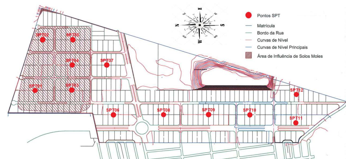
Figura 13 – Locação dos pontos das sondagens SPT
