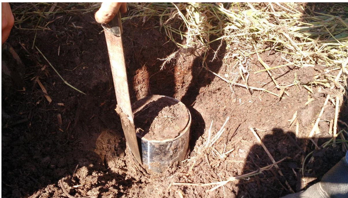
Figura 16 – Coleta de amostra indeformada no local.
