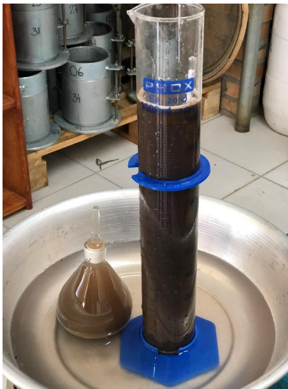
Figura 17 – Ensaio de granulometria com sedimentação
