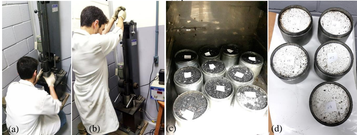
Figura 4.10 - (a) Posicionar molde no soquete de compactação, (b) aplicação dos golpes de compactação, (c) período em estufa e (d) período de resfriamento.
