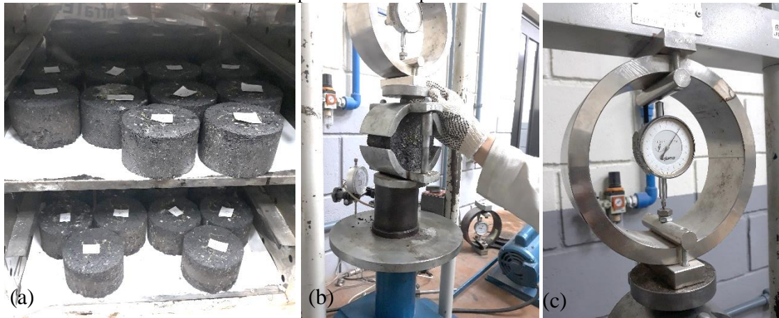
Figura 4.14 - (a) Período em estufa, (b) acomodação do PC no molde de compressão e (c) leitura durante o processo de rompimento.
