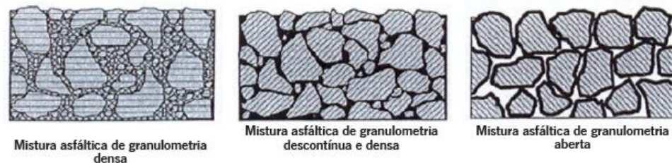
Figura 2.3 - Exemplo esquemático das classificações granulométrica das misturas.
