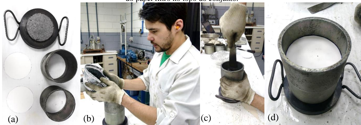
Figura 4.9 - (a) Conjunto de compactação, (b) adição da mistura no molde, (c) golpes com a espátula e (d) adição do papel filtro no topo do conjunto.
