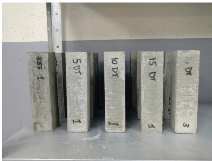
Figura 11 - Corpos de prova para ensaios mecânicos
