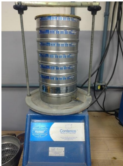
Figura 3 – Peneiramento do agregado.
