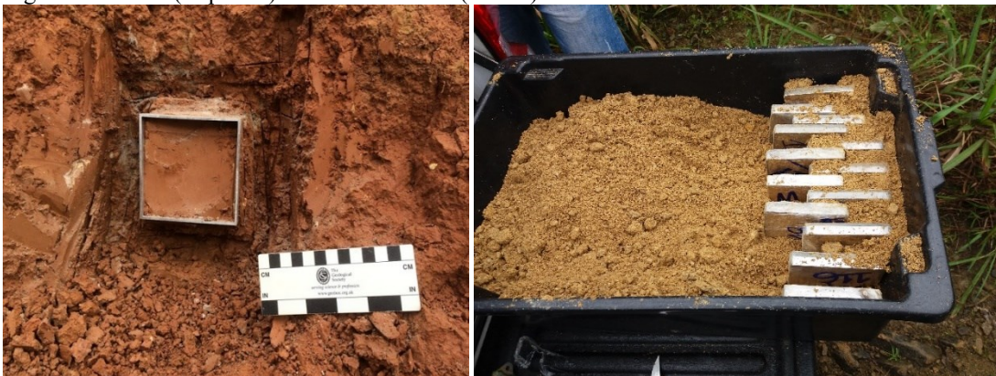
Figura 19. Coleta (esquerda) e armazenamento (direita) das amostras indeformadas.
