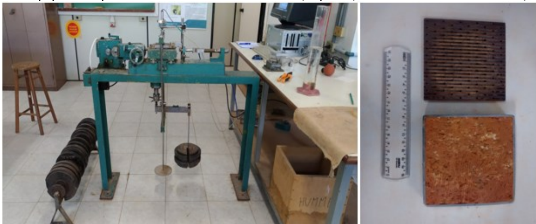
Figura 23. Equipamento para o ensaio de cisalhamento direto (esquerda) e moldes metálicos utilizados (direita).
