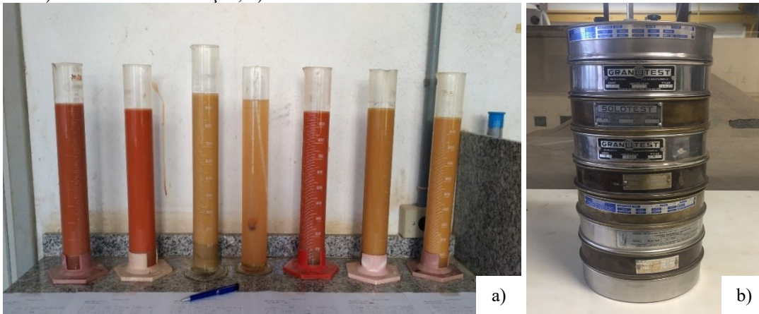
Figura 20. a) Ensaio de sedimentação; b) Peneiramento.
