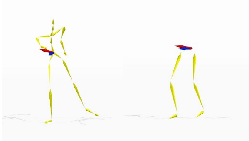
Figura 22 – À esquerda o esqueleto do sujeito capturado e os vetores de velocidade do quadril. À direita o resultado da camada da rede neural de destilização do movimento.
