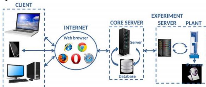
Figura 4 - Estrutura básica de um Laboratório Remoto.
