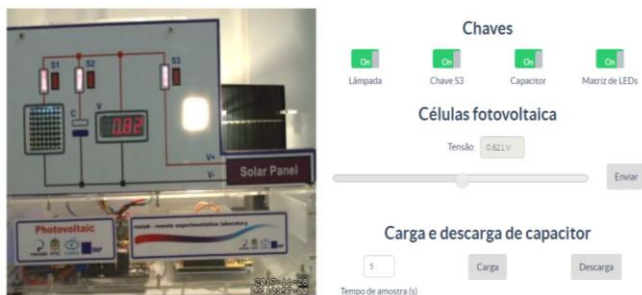
Figura 9 - LR Conversão de Energia Luminosa em Elétrica. Conversão de energia luminosa em energia elétrica
