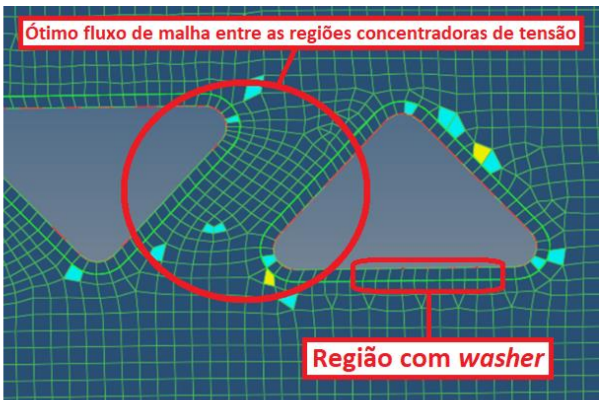
Figura 28 – Aplicação de “ washer ” no contorno de um concentrador de tensão.
