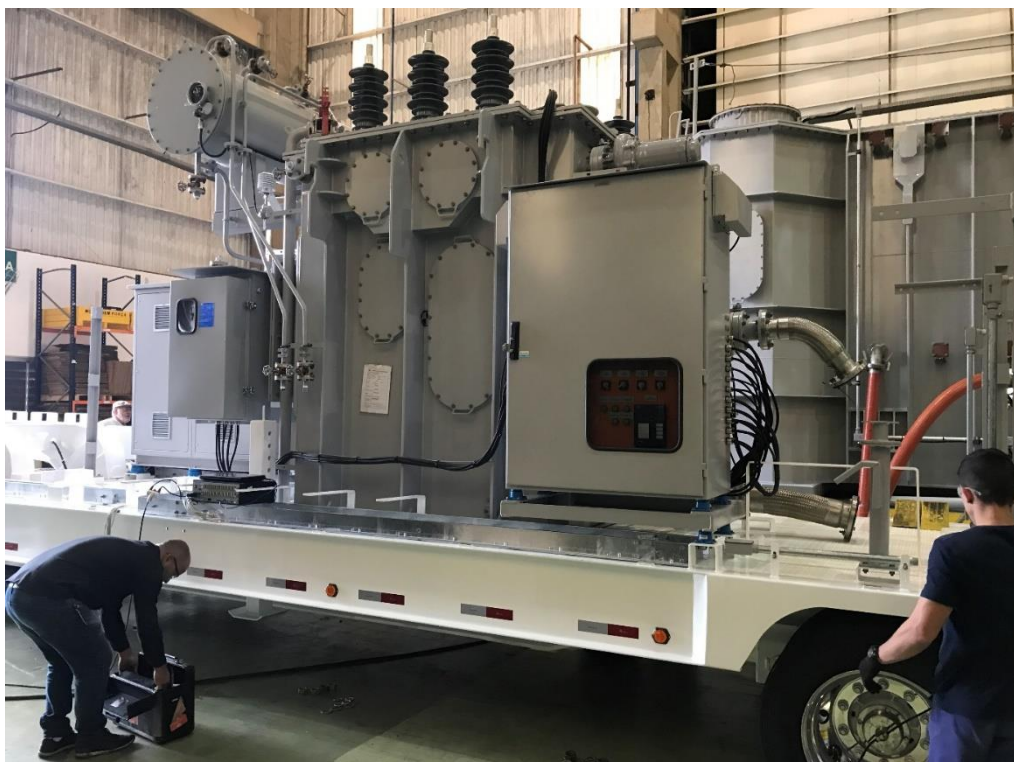
Figura 14 – Semirreboque Carrega Tudo carregado com subestação elétrica móvel.
