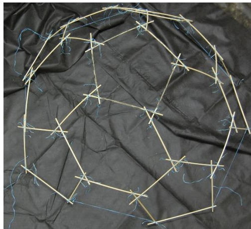
Pentágono central e cinco hexágonos no segundo nível e fechamento dos 5 pentágonos e dos 5 meios hexágonos do nível 3
