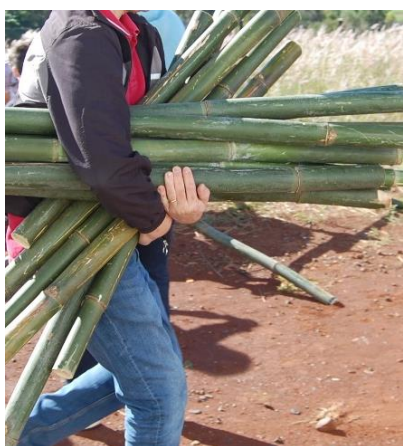
Peças de colmos de bambu tuldoides selecionados para serem usados em uma estrutura geodésica.
