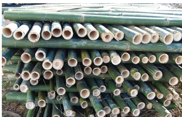
Peças de colmos de bambu tuldoides selecionados para serem usados em uma estrutura geodésica.
