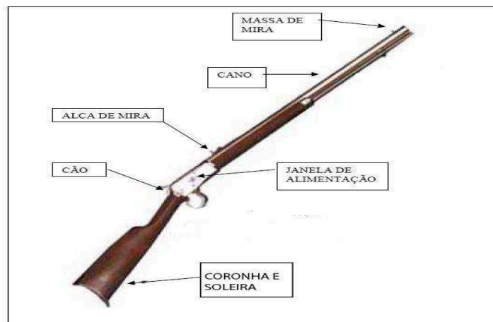
Figura 2.4 - Partes de uma espingarda.
