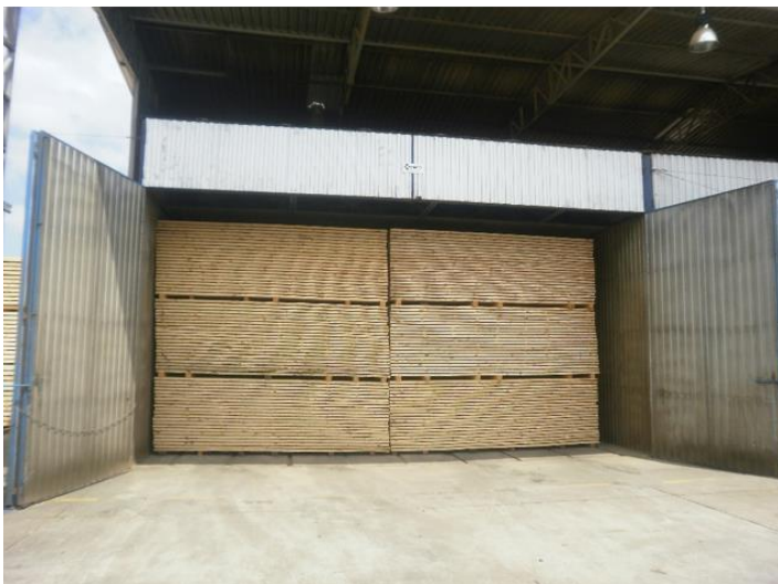
Figura 3.1–Vista dos componentes do interior do secador do carregamento das pilhas de madeira.
