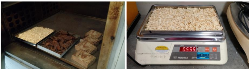
Figura 4.12 - Amostras de serragem, cascas e da madeira serrada na estufa (esquerda) e amostra de serragem na balança (direita).
