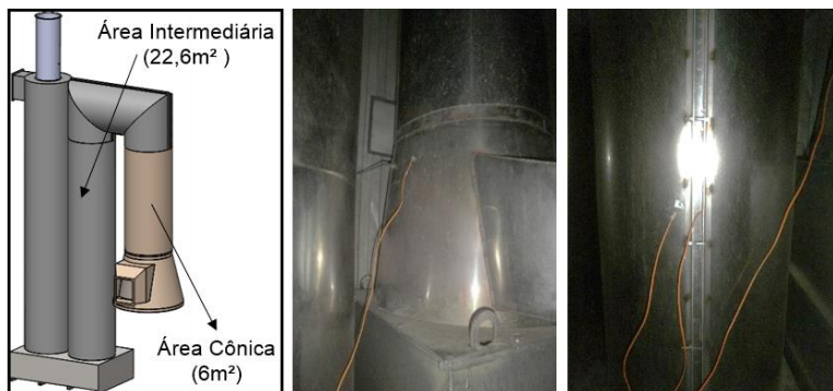
Figura 4.11 - Termopares instalados na parede externa do trocador de calor e região anular.
