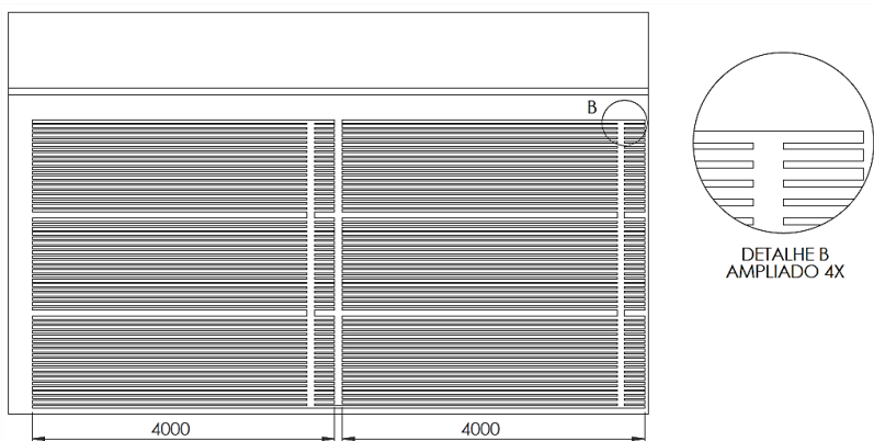
Figura 5.3 - Vista em corte paralelo à frente do secador (Dimensões em mm).
