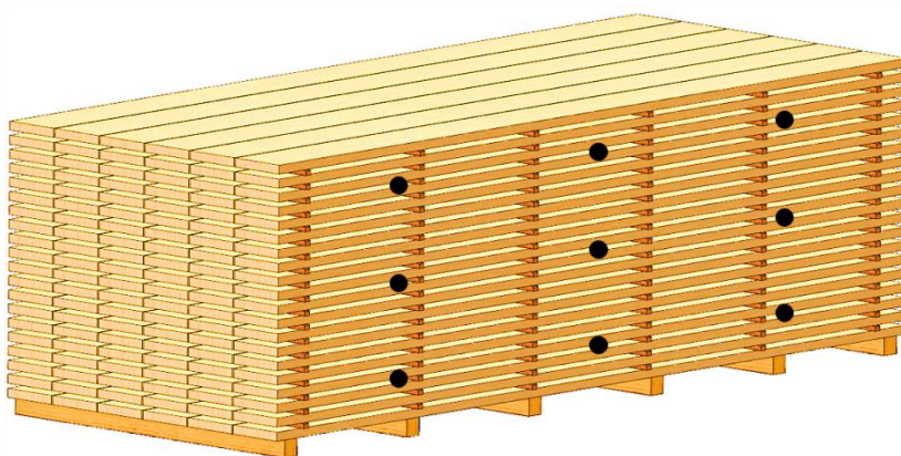
Figura 4.7 - Pontos de medição nos módulos das pilhas de madeira.
