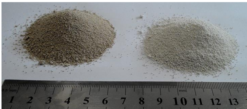
Figura 13 - Comparação visual das massas de porcelanato esmaltado (à esquerda) e porcelanato técnico (à direita).
