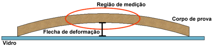
Figura 18 - Esquema para medição da flecha de deformação.
