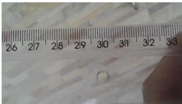
Com o parafuso no furo do meio da régua, prenda ela exatamente no centro de uma das extremidades do cabo de vassoura
