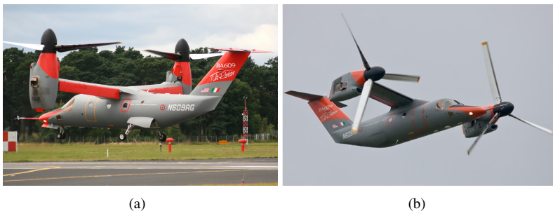
Figura 5 – Agusta Westland AW609 com rotores (a) na vertical e (b) inclinados na horizontal.
