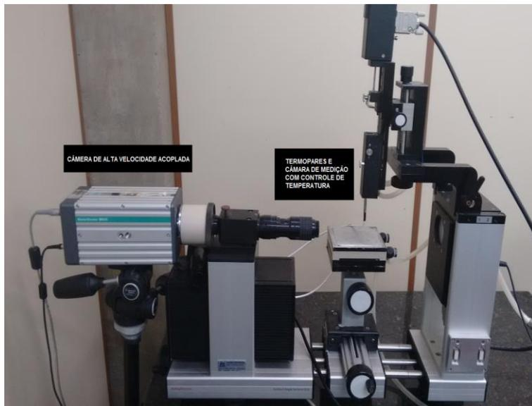
Figura 11: Goniômetro com câmera de alta velocidade acoplada.
