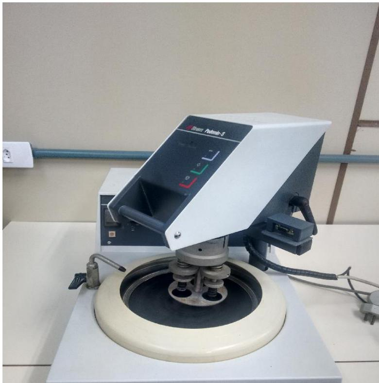
Figura 9: Politriz Struers Dap-V utilizada na preparação das amostras.
