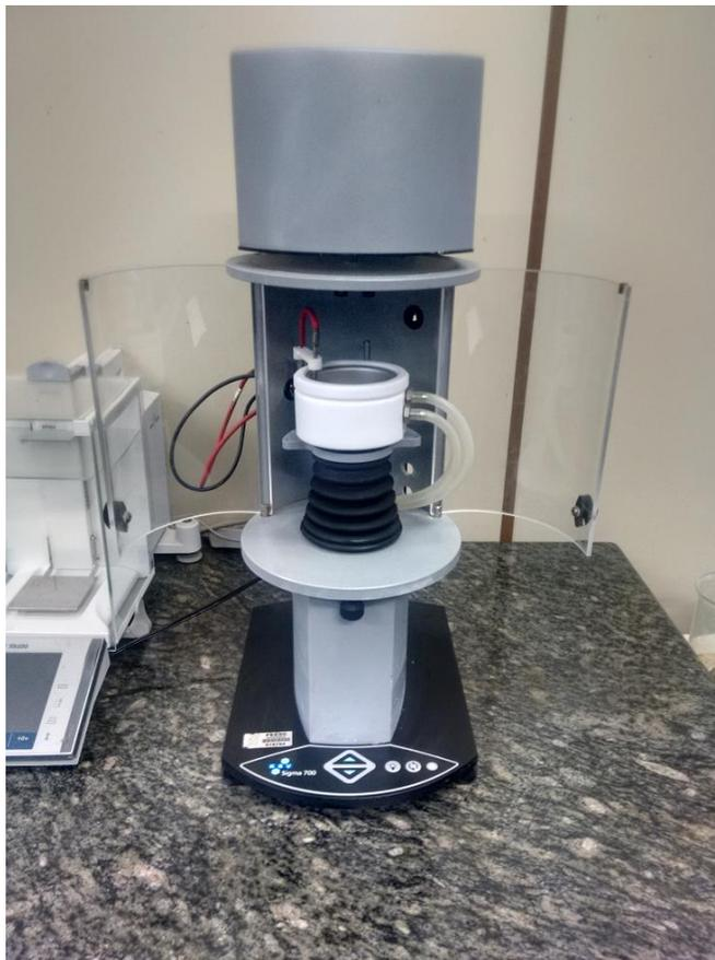
Figura 14: Tensiômetro Sigma700 ambos retirados de Zhao, 2004.
