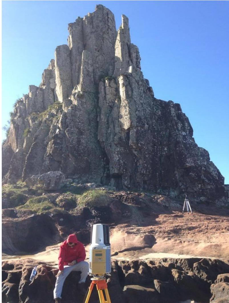
A última estacionada necessária (FIGURA 38), de número 5, utilizou como referência os alvos (9), (2) e (4) distante do aparelho à 13,88 m; 37,45 m e 50,13 m respectivamente, o tempo de aquisição para o escaneamento foi de 9 min e 23 s, e para as imagens digitais o tempo foi de 1 min e 20 s, total de dados válidos 68%.
