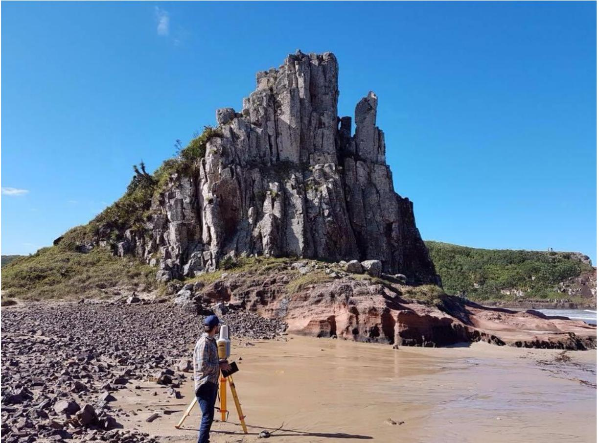
A quarta escaneada (FIGURA 37) tomou como referência os alvos (4), (7) e (8) com distância para o aparelho de 77,10 m; 15,25 m; 12,71 m respectivamente. O tempo de aquisição para a cena foi de 12 min e 55 s, e das imagens digitais de 1 min e 45 s, o total de dados válidos 56%.
