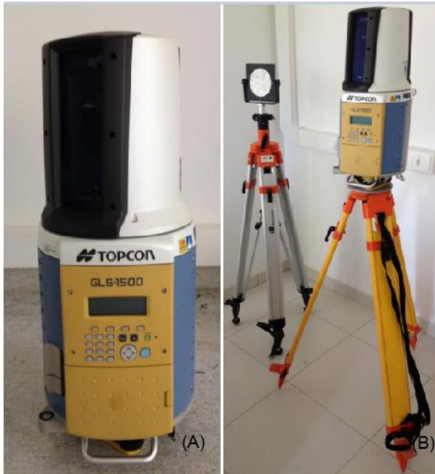
Os alvos são usados para que o aparelho se referencie espacialmente e são dispostos no local utilizando-se de tripés ou fixando diretamente no objeto, são feitos de material especial do qual o *laser scanner* seja capaz de reconhecer seu centro e registrar sua posição dentro da nuvem de pontos. Os dados após adquiridos são importados do cartão de memória para um computador e recebem o tratamento no software *ScanMaster2* desenvolvido pela *TOPCON*.
