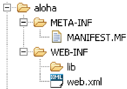
Figura 5.7 - Estrutura de diretórios e arquivos do Tomcat
