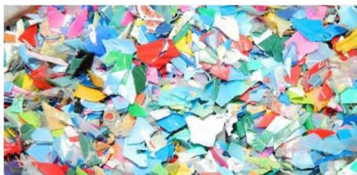
Figura 42 – Resíduos plásticos triturados na etapa de moagem. Fonte: SINDPLAST (2011, p. 15)
