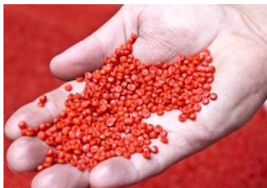
Figura 41 – Grãos plásticos ( pellets ) produzidos na etapa de granulação. Fonte: American Chemistry Council (Disponível em: https://plastics.americanchemistry.com/Jobs/EconomicStatistics/Plastics - Statistics/ )
