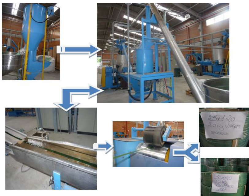
Figura 38 – Processo para produzir as fitas de arquear: homogeneização, aglutinação e extrusão – Palhoça, SC.
