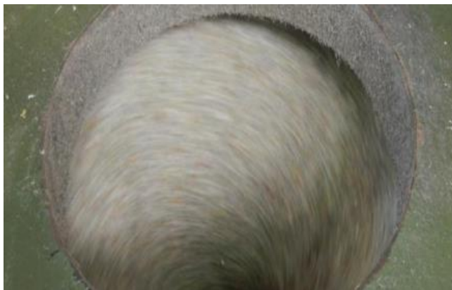
Figura 44 – Aglutinadora de resíduos plásticos triturados. Fonte: SINDPLAST (2011, p. 17).
