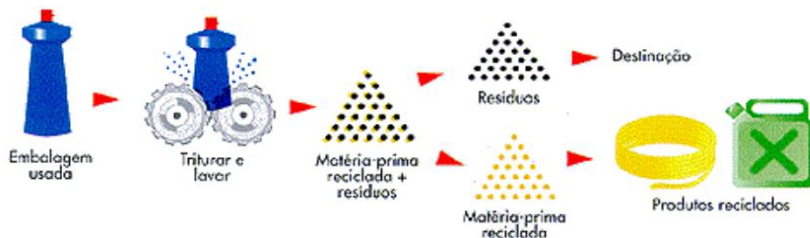
Figura 4 – Fluxograma das etapas da reciclagem mecânica.
