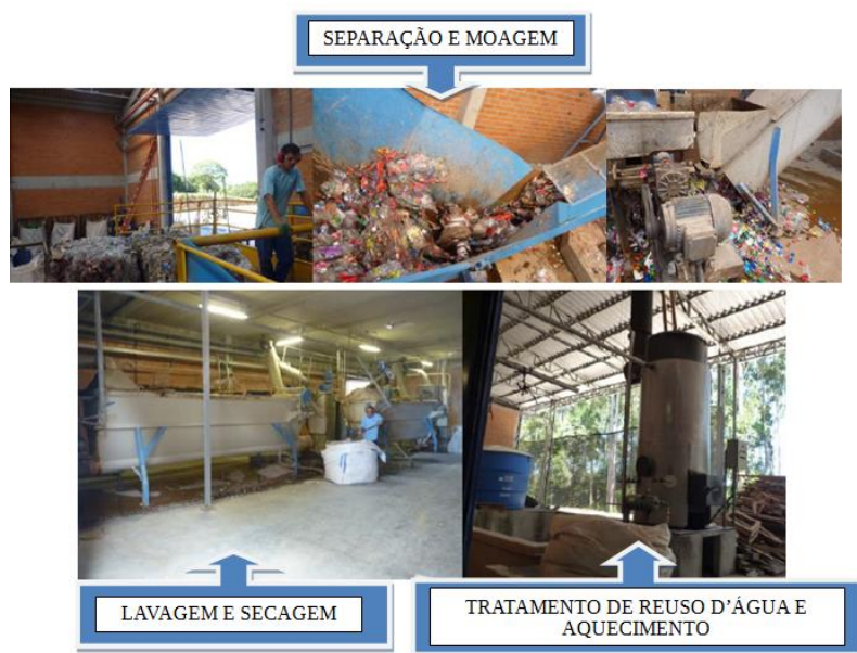
Figura 37 – Primeiras etapas da reciclagem mecânica – separação, moagem, lavagem e secagem – Indústria A.
