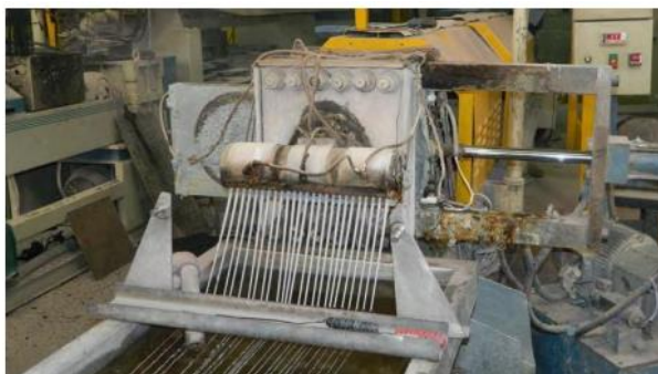
Figura 40 – “Espaguetes” produzidos pela extrusora.
