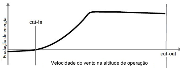
Figura 30 – Curva de potência genérica aplicável tanto a uma WT quanto a um PK.
