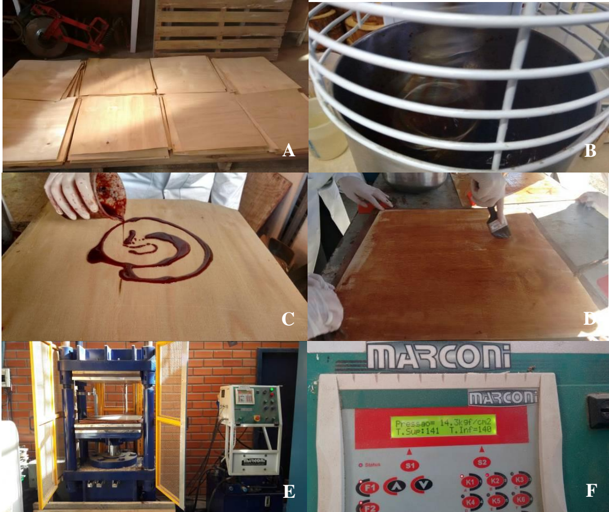
Figura 5 – Confeção dos painéis compensados. Lâminas para montagem dos painéis (A); Mistura do adesivo em bateadeira industrial (B); Pesagem da lâmina com adesivo, de acordo com a gramatura (C); Distribuição do adesivo, em linha de cola simples (D); Prensa utilizada na confecção dos painéis (E); Monitor da prensa a quente, com dados de temperatura, pressão e tempo de prensagem (F).
