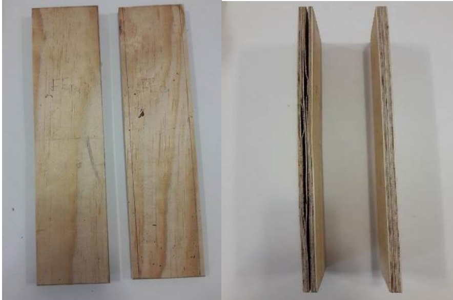
Figura 9 – Visualização dos corpos de prova com e sem delaminação.
