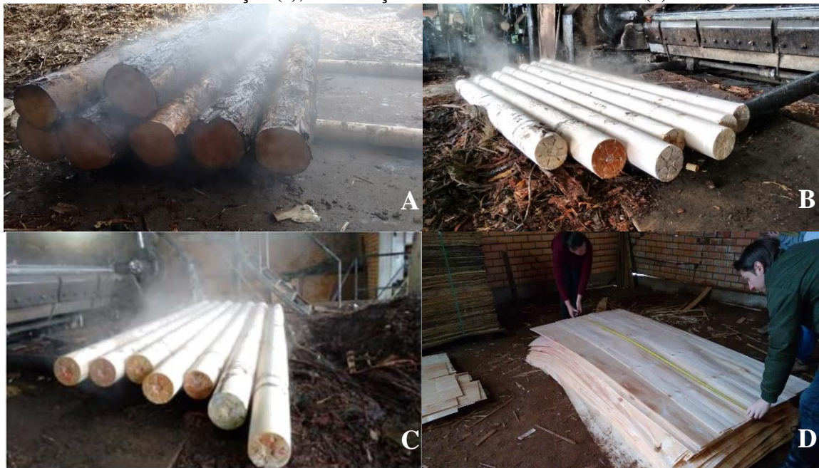
Figura 4 – Etapas do processo de avaliação do rendimento em laminação. Toras após o processo de aquecimento (a), Toras após o desenrolamento até a forma cilíndrica (b), rolo resto obtido ao fim da laminação (c), mensuração das dimensões das lâminas (d).
