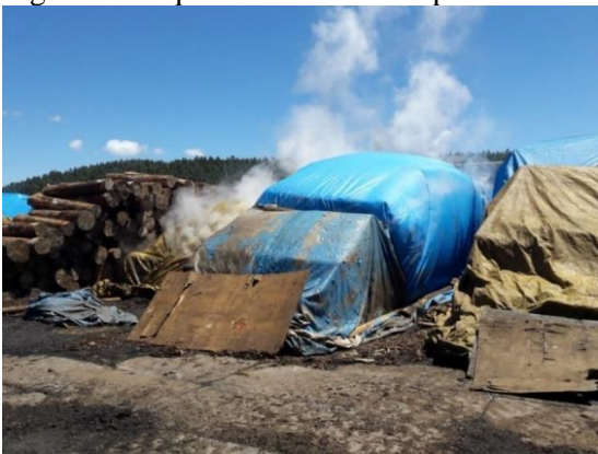
Figura 3 – Aquecimento de toras por meio de vapor saturado.
