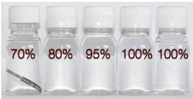
Figura 5 – Ilustração simulando banhos em resina LR White Hard Grade®, em várias concentrações para desidratação das amostras
