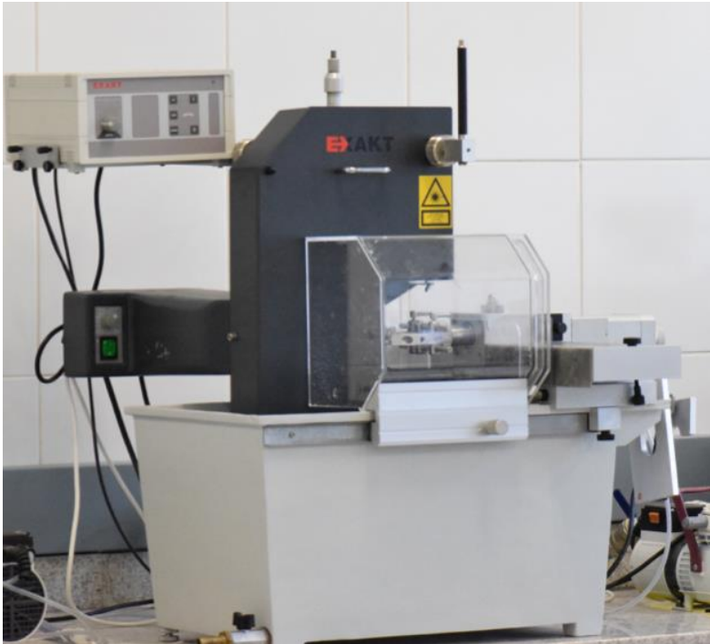
Figura 2 – Sistema Exakt ® - maquina de corte
