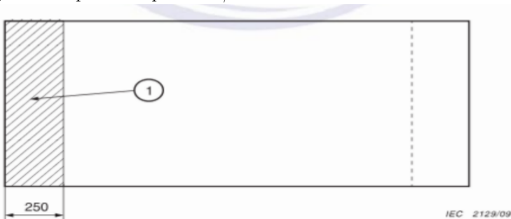
Figura 20: Área para distribuição da carga para o teste de estabilidade longitudinal quando a peseira e/ou cabeceira serem removíveis.
