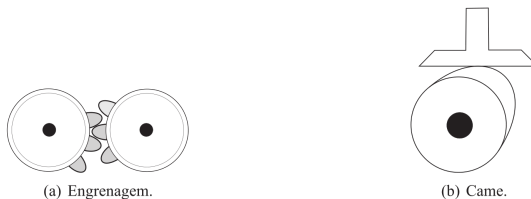
Figura 26: Pares cinemáticos superiores.
