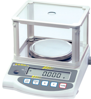
Figura 60 – Balança digital usada no método das densidades (KERN EW220 3NM - resolução 1mg).
