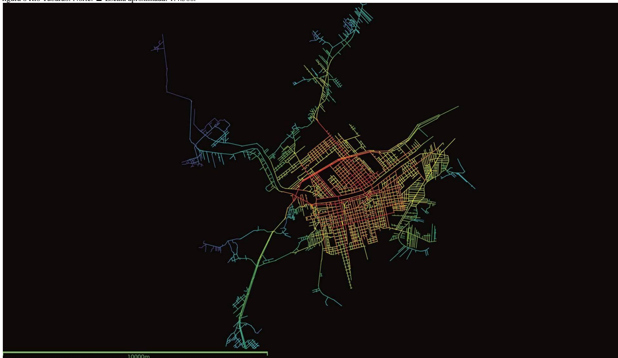
Figura 16 – Mapa axial de integração global de Tubarão. Em escala cromática, dos menores (azul) aos maiores (vermelho) valores de integração. O vazio que corta o mapa no sentido leste-oeste figura o Rio Tubarão. Norte: ▲ Escala aproximada: 1:4.500.
