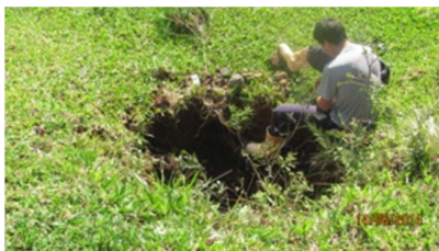
Figura 31 - Estrutura de abatimento com clastos e matacões expostos junto à estrutura de abatimento (artesianismo).
