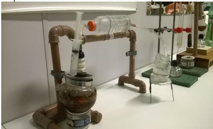
Figura 20. Experimento com material alternativo: alambique
