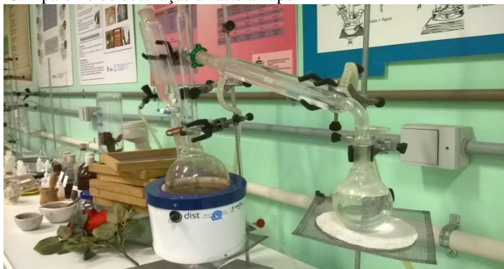
Figura 15. Aparelho de destilação arraste a vapor
