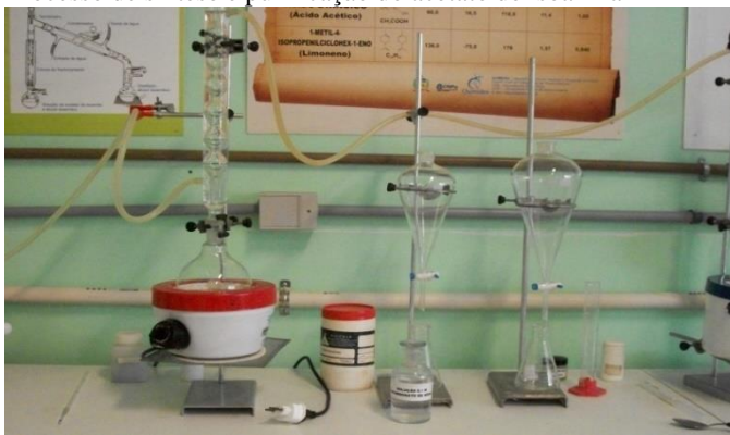
Figura 12. Processo de síntese e purificação do acetato de isoamila
