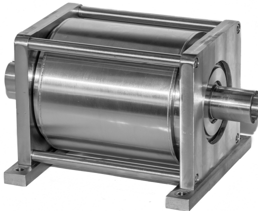
Figura 3.12 – Arranjo de Cilindros Concêntricos de Halbach desenvolvido por Trevizoli et al. (2015).
