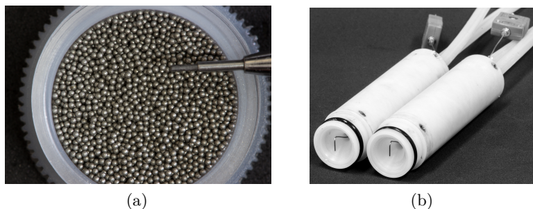
Figura 3.4 – Componentes do RMA: (a) Esferas de Gd de 0,55 mm de diâmetro médio e adaptador regenerador-tubo; (b) Termopares e adaptadores montados na carcaça auxiliar.
