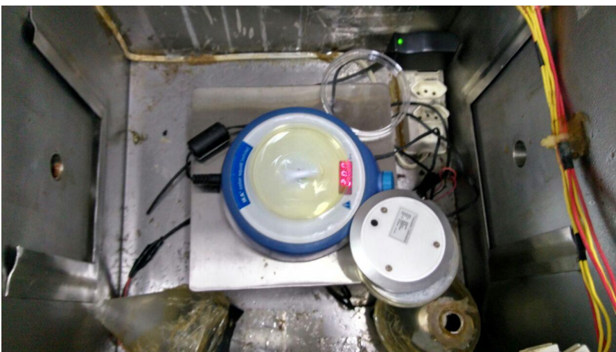
Figura 12 - Radiômetro ao lado da amostra dentro do equipamento de inativação
