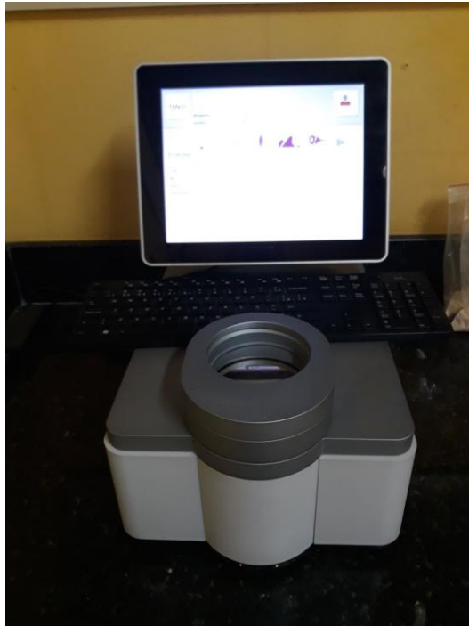
Figura 10. Espectrômetro tango da Bruker para análise NIR;
