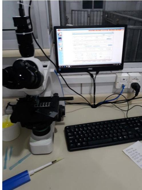
Figura 1. Microscópio óptico ligado ao computador com MAGAVISION (software para análise de sêmen);
