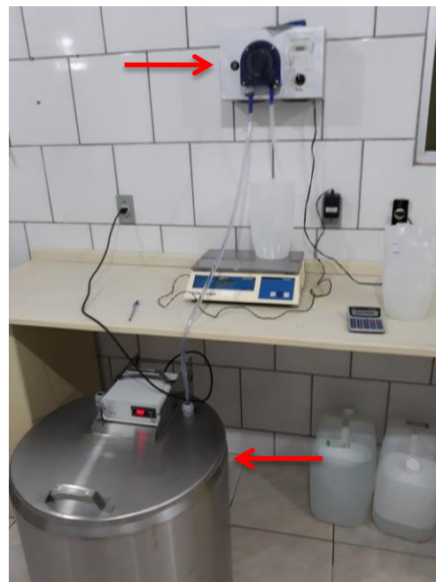
Figura 2. Equipamento usado para preparo do diluente (na parte de baixo) e para mistura com o sêmen (na parte de cima);
