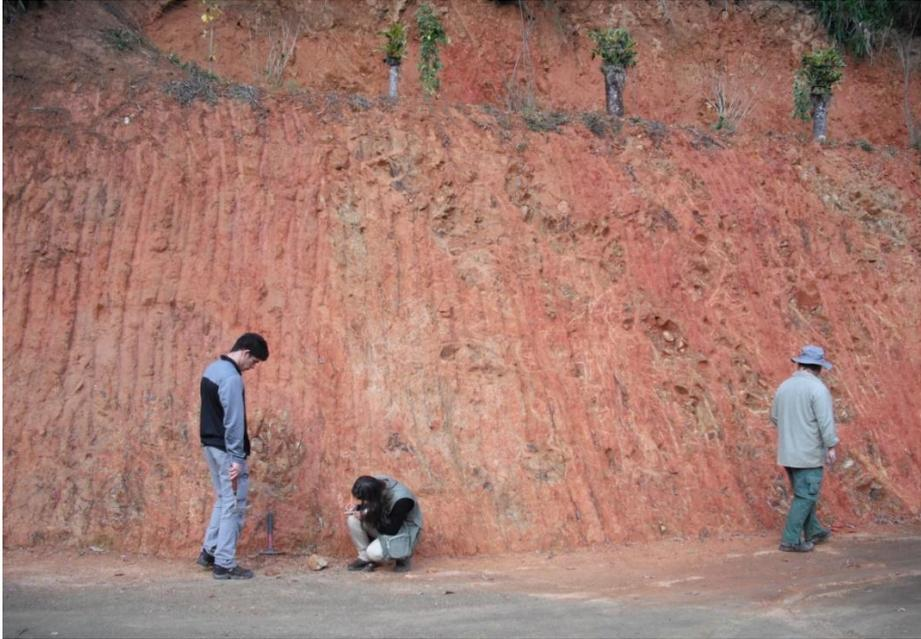
A rocha intemperizada tem coloração avermelhada. Em ambos afloramentos foi possível observar sistema de fraturas com minerais de alteração e cataclase (Figura 35A e B). No ponto IA04 o granito tem lineação de estiramento dada por *ribbons* de quartzo com caimento 45/330 Az.
