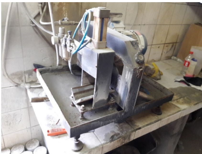
Figura 10 – Equipamento utilizado para a retificação na empresa Concretar (Fonte: Autor)
