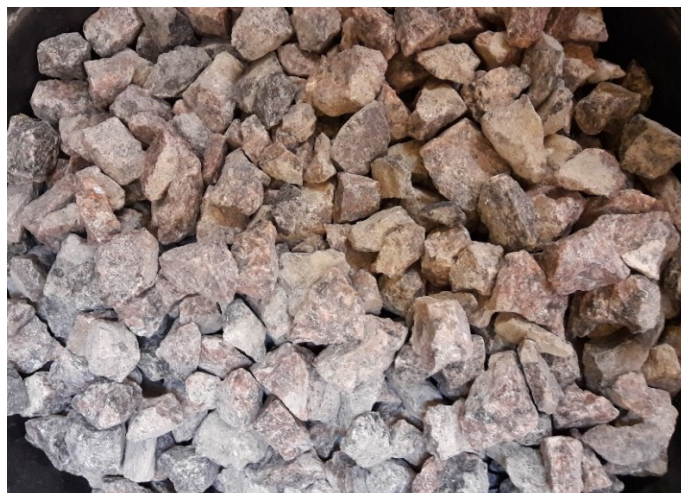
Figura 2- Brita 3/4 selecionada para produção das amostras de concreto (Fonte: Autor)
