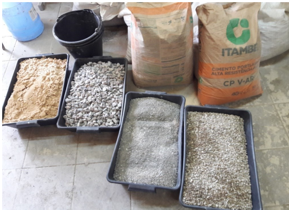
Figura 6 – Seleção e pesagem dos materiais utilizado na produção do concreto (Fonte: Autor)
