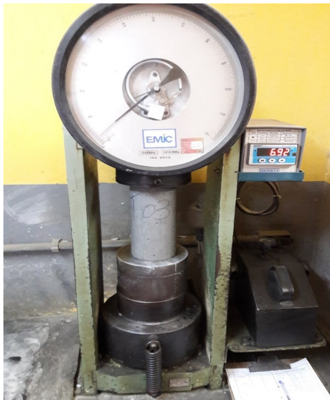
Figura 10 – Prensa “Emic” utilizada para o ensaio de compressão na empresa Concretar (Fonte: Autor)
