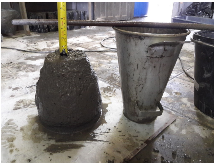
Figura 8 – Teste de Slump (Fonte: Autor)
