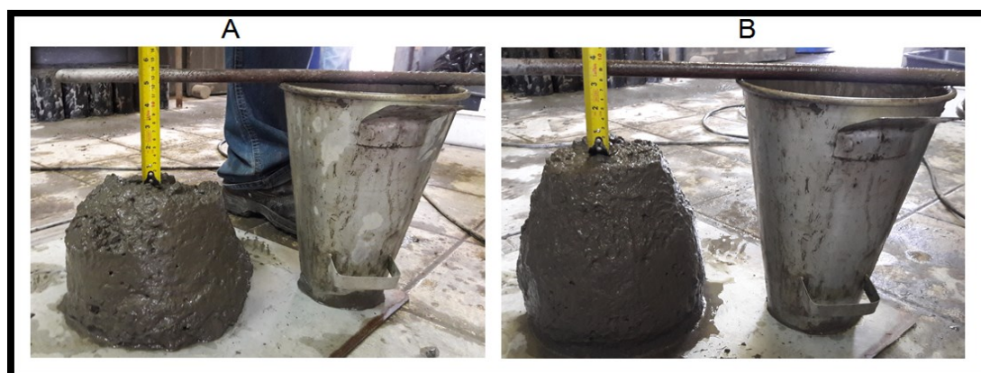
Figura 11 - Realização do teste de Slump (Fonte: Autor)
