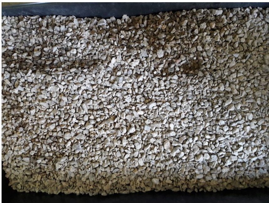
Figura 1- Brita 0 selecionada para produção das amostras de concreto (Fonte: Autor)
