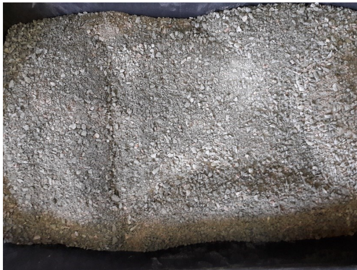
Figura 4 – Areia grossa selecionada para produção das amostras de concreto (Fonte: Autor)
