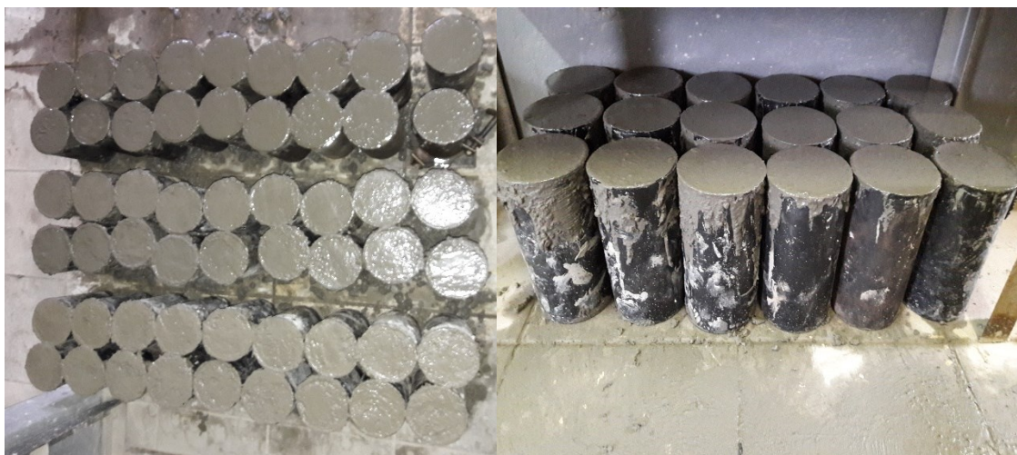
Figura 9 – Corpos-de-prova moldados (Fonte: Autor)
