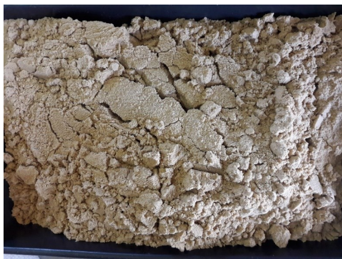
Figura 3 - Areia fina selecionada para produção das amostras de concreto (Fonte: Autor)
