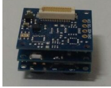
Figura 14: Sistema de detecção de movimentação
