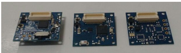
Figura 13: Tinyduino, shield BLE e shield de acelerômetro
