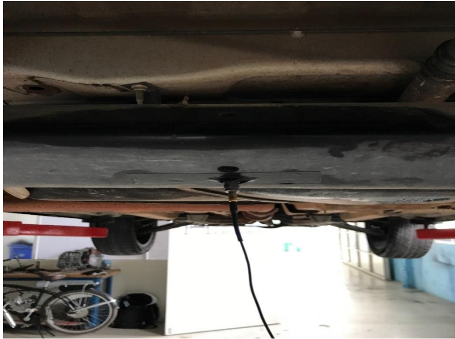
Figura 30 – Localização do acelerômetro
