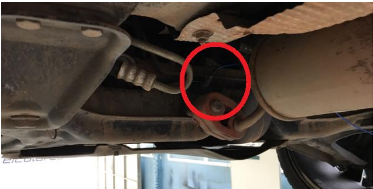
Figura 32 – Localização do acelerômetro
