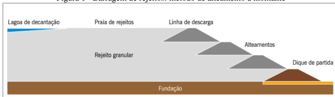
Figura 1 - Barragem de rejeitos: método de alteamento à montante
