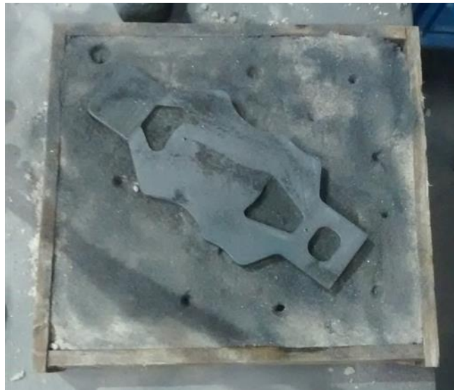
Figura 32 Posicionamento da peça no molde
