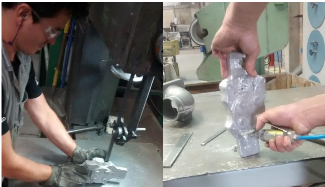
Figura 39 Retirada do massalote e dos canais
