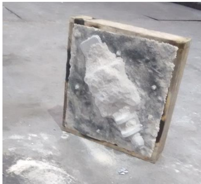
Figura 37 Manga de eixo antes da retirada do molde de areia
