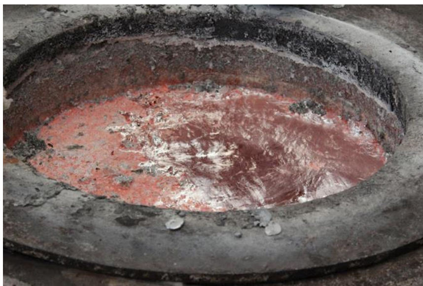
Figura 34 Liga Al-Si7-Mg0,3 fundida
