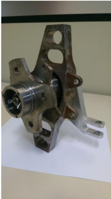
Figura 20 Conjunto da manga de eixo ao cubo de roda do protótipo de 2015
