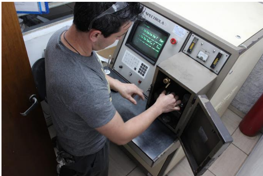
Figura 35 Obtenção da composição da liga por meio de espectrometria de emissão ótica
