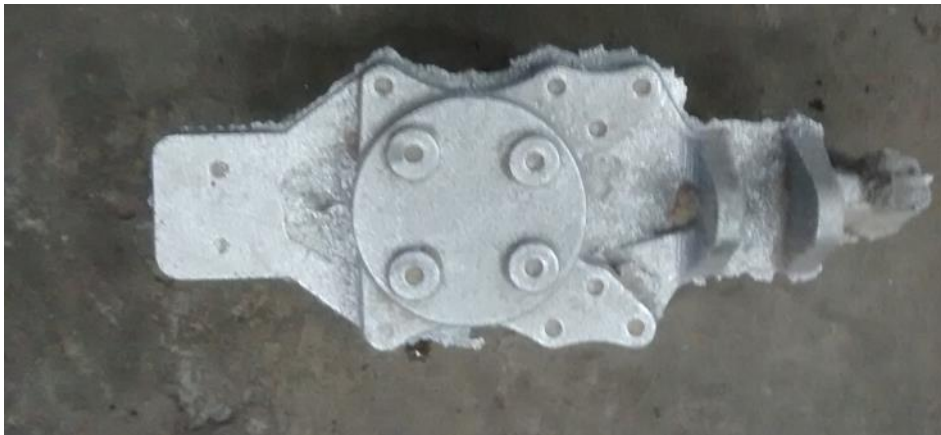
Figura 38 Manga de eixo sem o processo de acabamento
