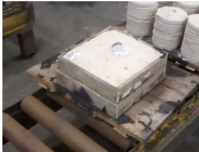
Figura 36 Molde com suas cavidades preenchidas de alumínio fundido
