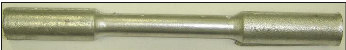
Figura 41 Formato dos corpos de prova para ensaios de resistência a tração segundo a NBR ISO 6892 - 2002
