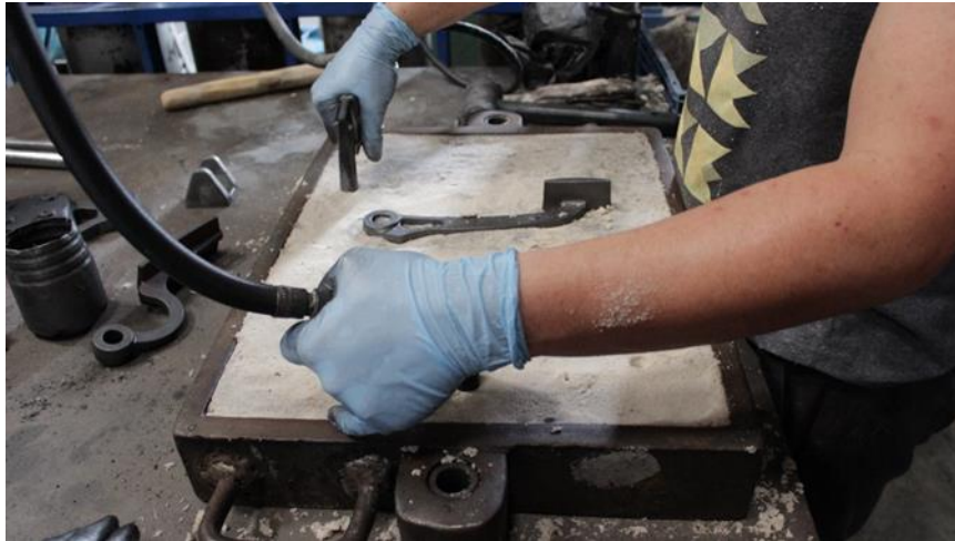
Figura 33 Injeção de CO 2 pelos orifícios do molde
