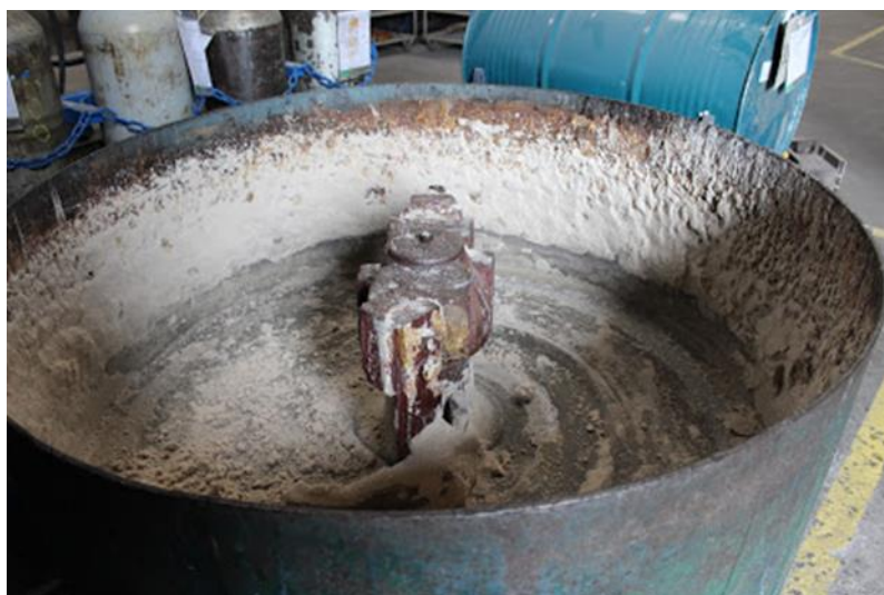
Figura 30 Areia seca sendo misturada ao silicato
