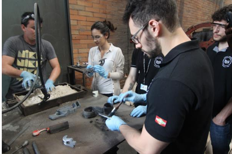
Figura 31 Modelo sendo coberto por uma solução de grafite
