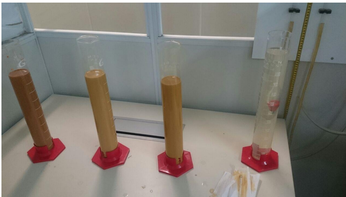
Figura 28 – Execução do Ensaio de Sedimentação
