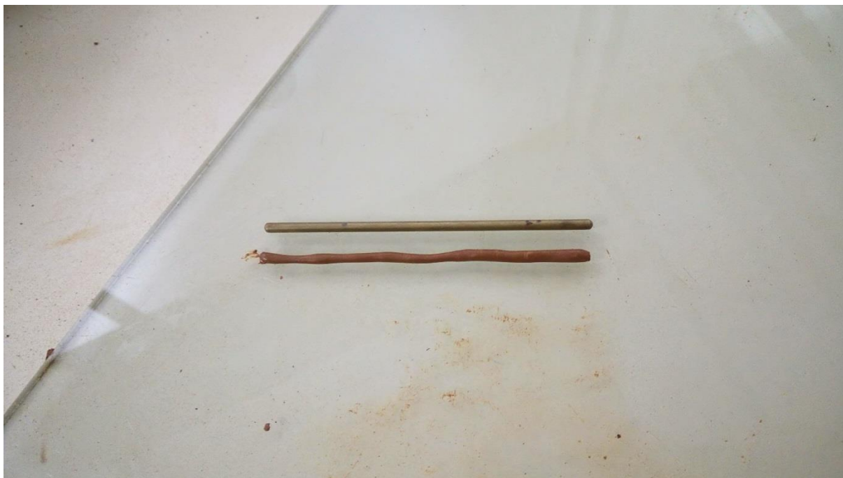
Figura 36 – Execução do Ensaio de Limite de Plasticidade
