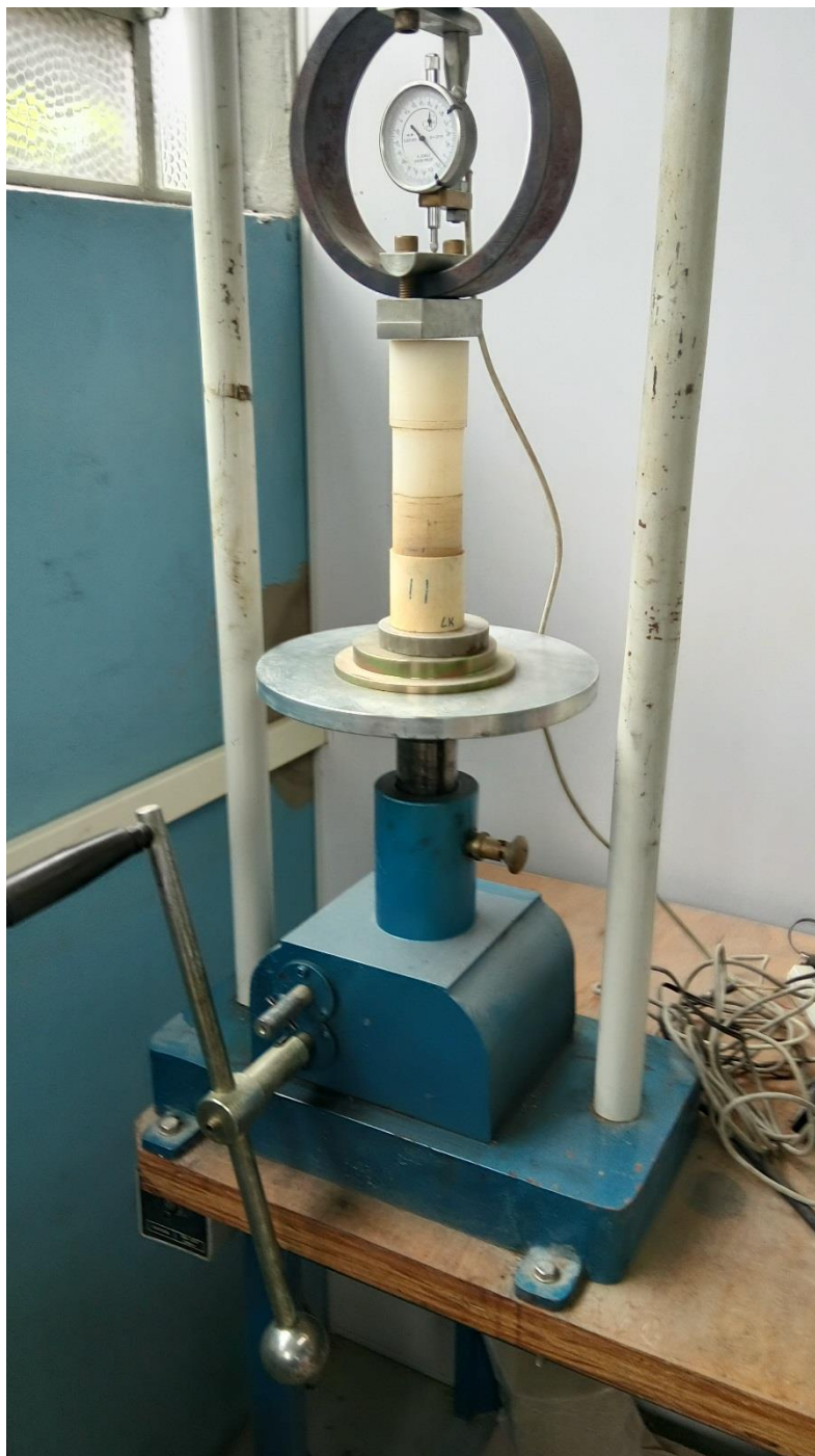
Figura 29 – Compactação de Corpo de Prova Remoldado
