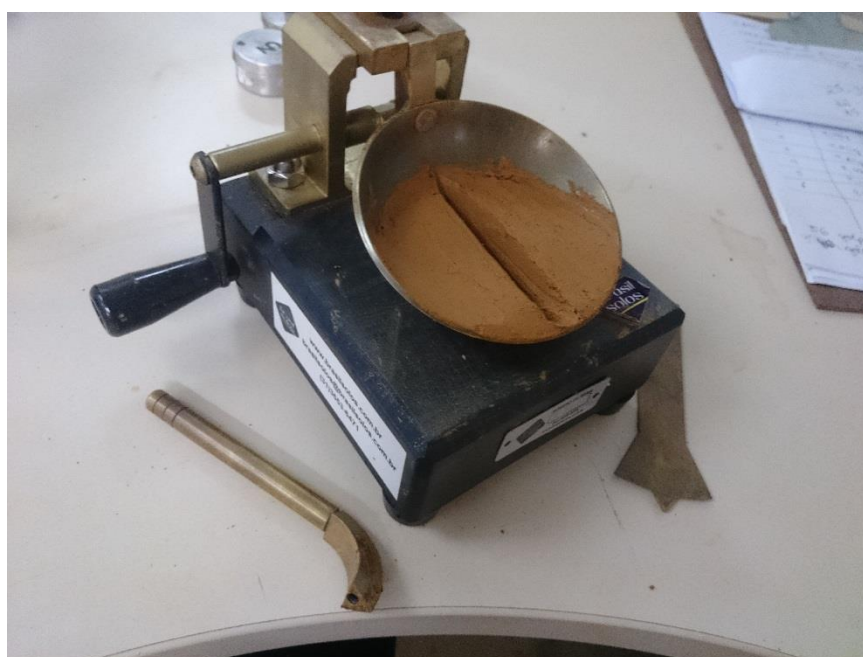
Figura 35 – Execução do Ensaio de Limite de Liquidez
