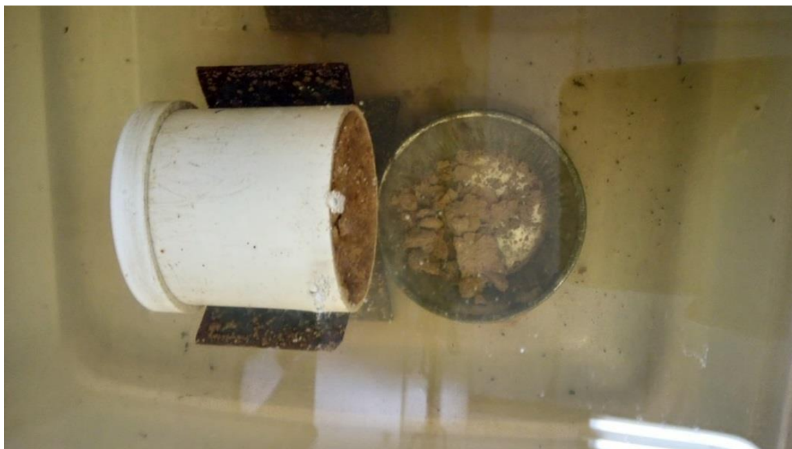
Figura 39 – Corpo de Prova após 20 horas de Imersão
