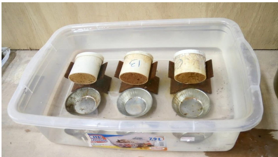
Figura 38 – Corpos de Prova em Imersão
