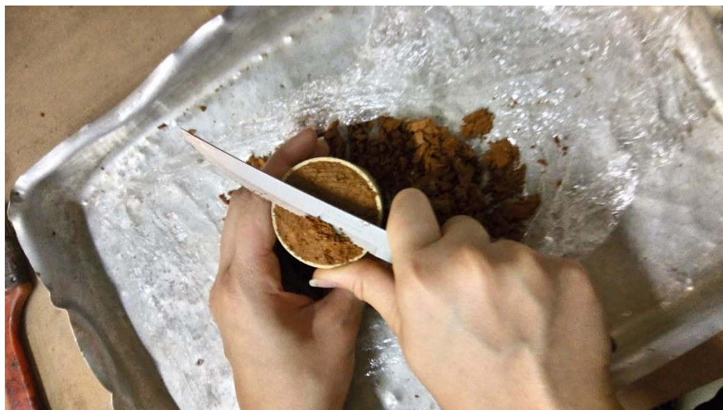
Figura 27 – Arrasamento dos Corpos de Prova
