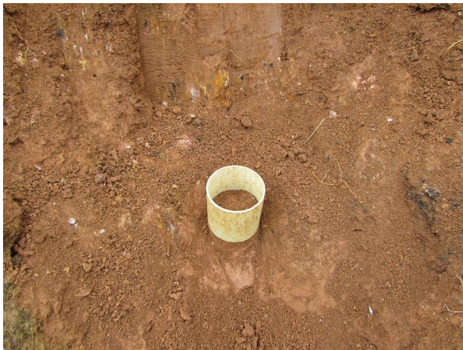
Figura 26 – Extração de Corpos de Prova
