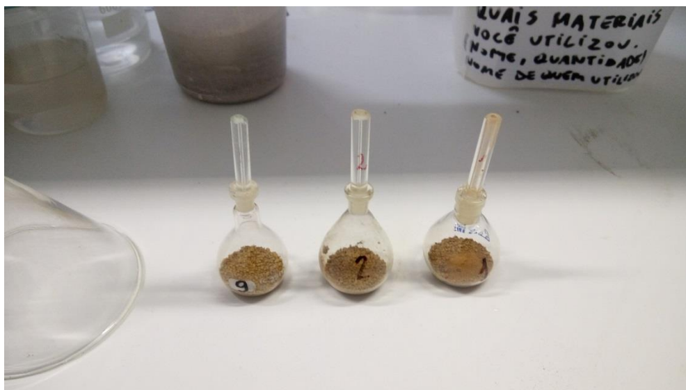
Figura 30 – Conjunto Picnômetro e Solo
