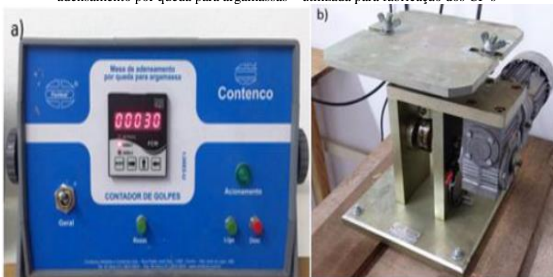
Figura 20 - a) Imagem ilustrativa de um Contador de Golpes Automático; b) Mesa de adensamento por queda para argamassas – utilizada para fabricação dos CP's
