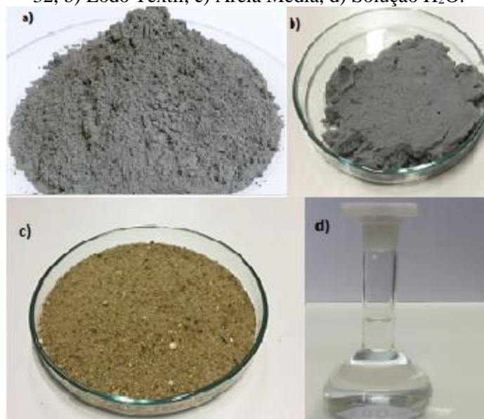
Figura 10 - Matérias primas utilizadas na preparação da argamassa experimental: a) CP II – F – 32, b) Lodo Têxtil, c) Areia Média, d) Solução H 2 O.
