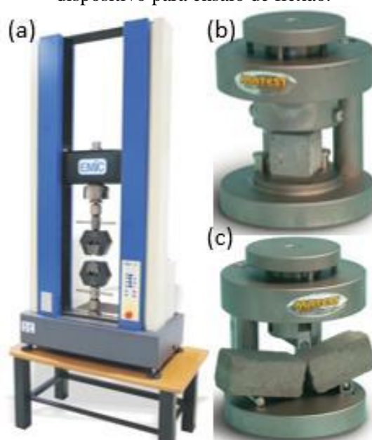
Figura 24 - (a) máquina de carga universal; (b) dispositivo para ensaio de compressão; (c) dispositivo para ensaio de flexão.
