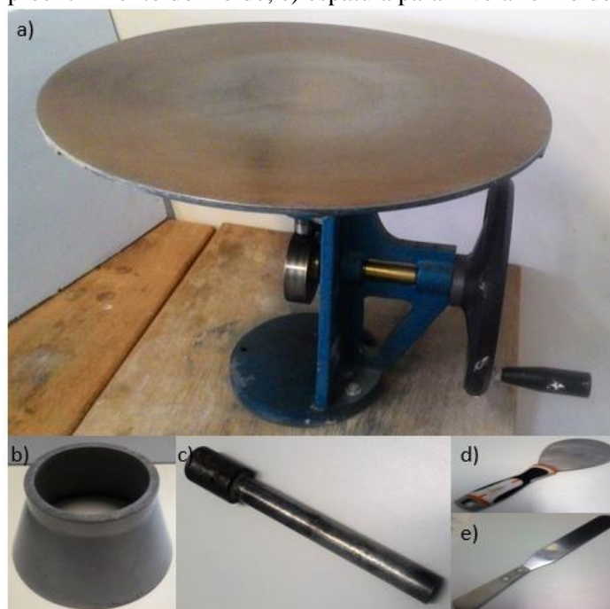
Figura 23 - a) mesa para realização do FTT; b) molde tronco cônico; c) soquete; d) espátula para preenchimento do molde; e) espátula para nivelar o molde.
