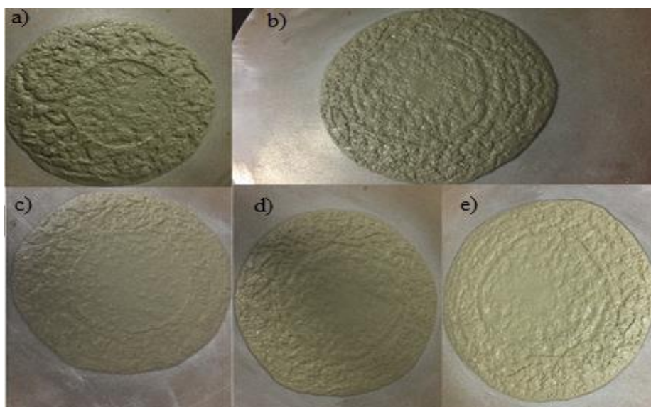
Figura 28 - Ensaio de espalhamento para determinação da razão sólido/líquido a ser utilizada nas diferentes adições de lodo têxtil. a) REF; b) 5%; c) 10%; d) 15%; e) 20%.
