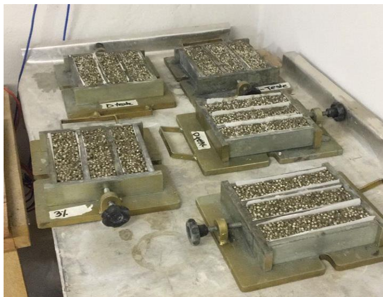
Figura 11 - Moldagem da argamassa.
