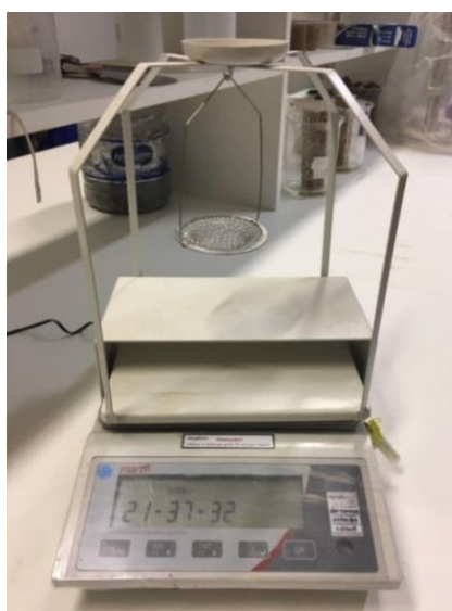
Figura 16 - Balança de precisão com suporte para pesagem imersa.
