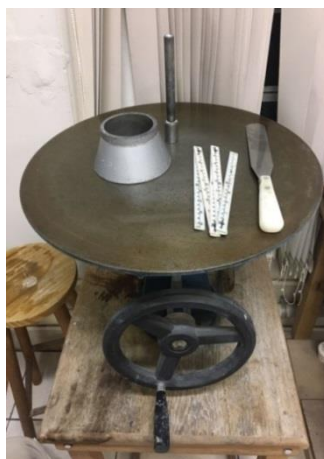
Figura 10 - Equipamentos e instrumentos utilizados no Flow Table.
