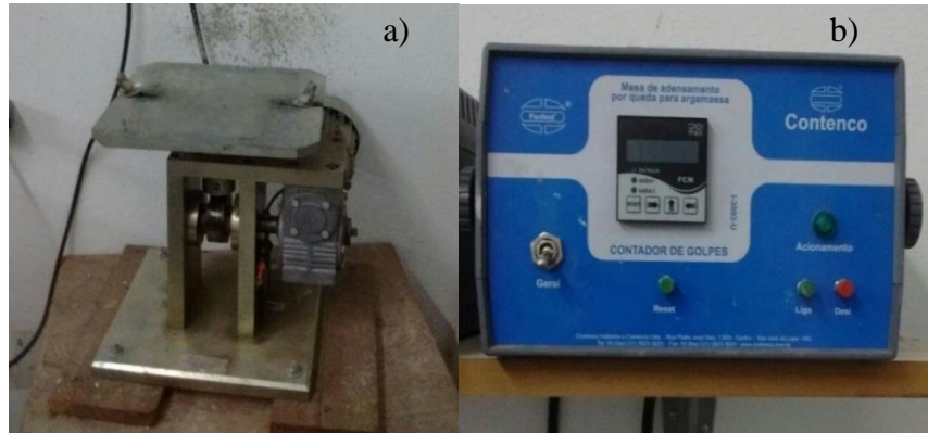
Figura 12 - Contador de golpes e mesa de adensamento.
