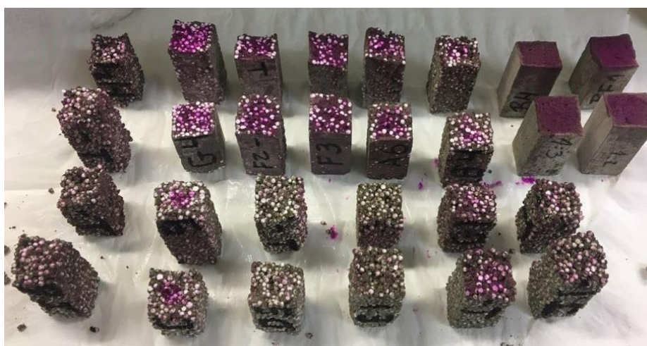
Figura 19 - Frente de Carbonatação.
