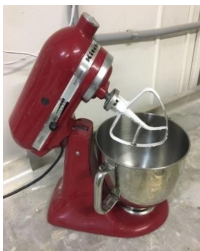
Figura 7 - Misturador de alta potência.
