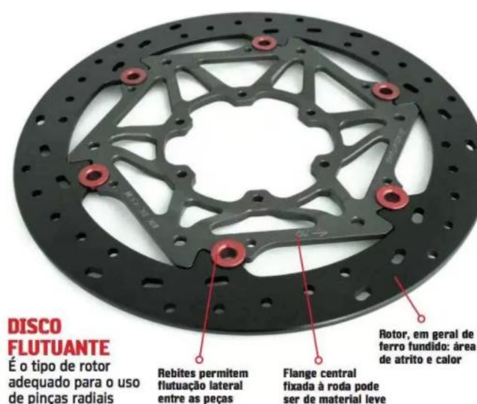
Figura 20 - Freio a disco tipo flutuante
