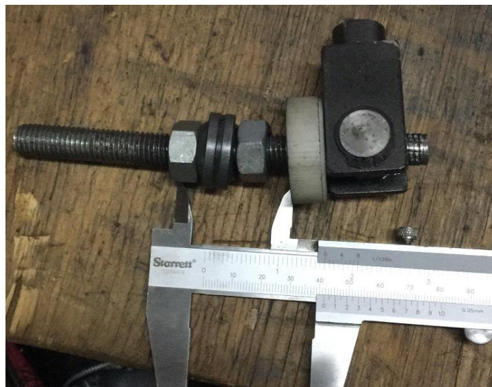
Figura 57 – Medição da distância de atuação da balance bar (traseira)
