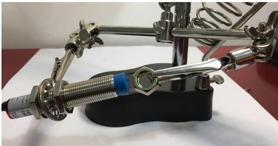
Figura 38 – Verificação da taxa de medição do sensor indutivo switch
