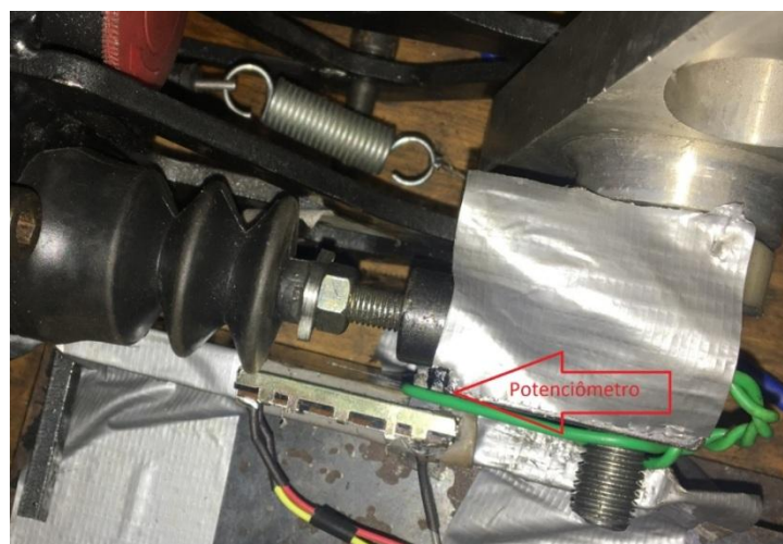
Figura 48 – Deslocamento do cilindro mestre
