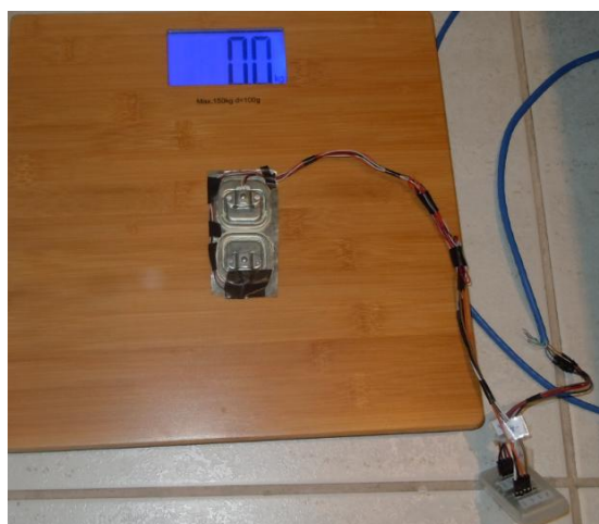
Figura 34 – Calibração da célula de carga
