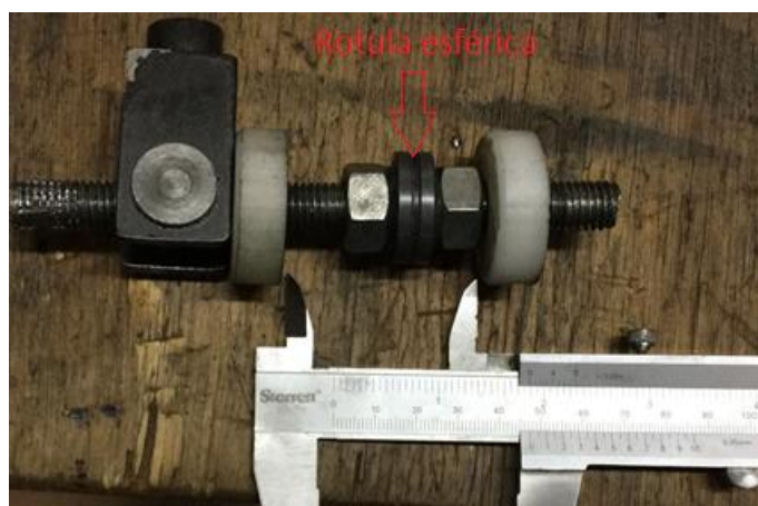
Figura 54 – Medição da distância de atuação da balance bar (dianteira)
